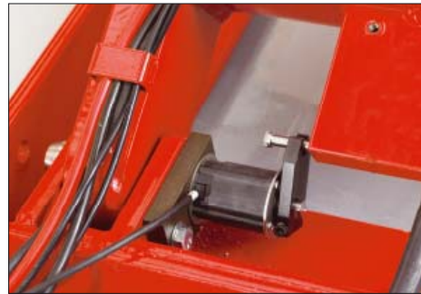
Низковольтная электронная система обратной связи** контролирует уровень путей подъемника и безопасно останавливает его при наличии препятствия.
