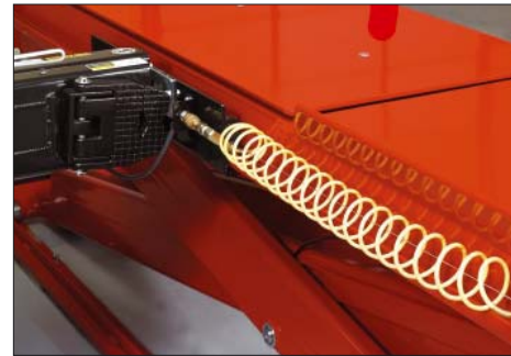
Стандартная пневматическая линия встроена в подъемник и обеспечивает разъемы подключения пневматического инструмента и траверс спереди и сзади.
