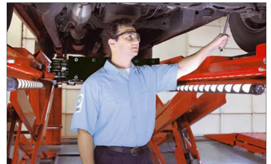
Комплект освещения для подъёмников Hunter серии RX устанавливается как опция, или ставится уже на действующий подъёмник RX.
