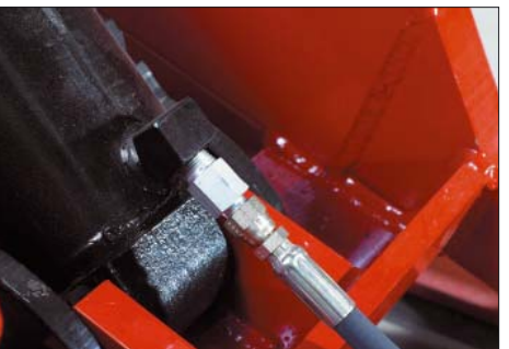
Гидравлический предохранитель останавливает подъемник в случае потери давления.
