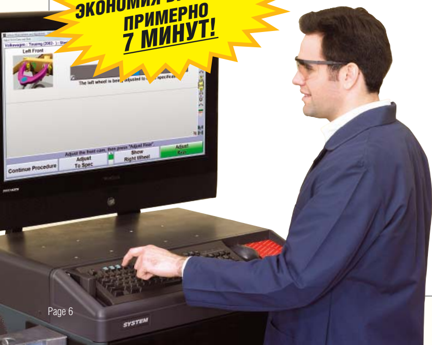
Экран регулировки переднего эксцентрика слева на соответствие значению справа.
