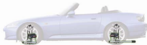
... реверсивное расположение для "обхода" низкого переднего спойлера.
